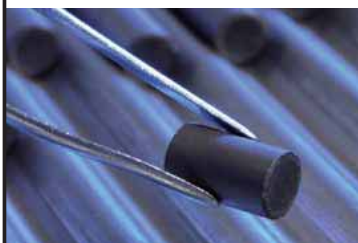
Pastille de combustible MOX du type de celles qui étaient fabriquées à l'ATPu. © areva nc
